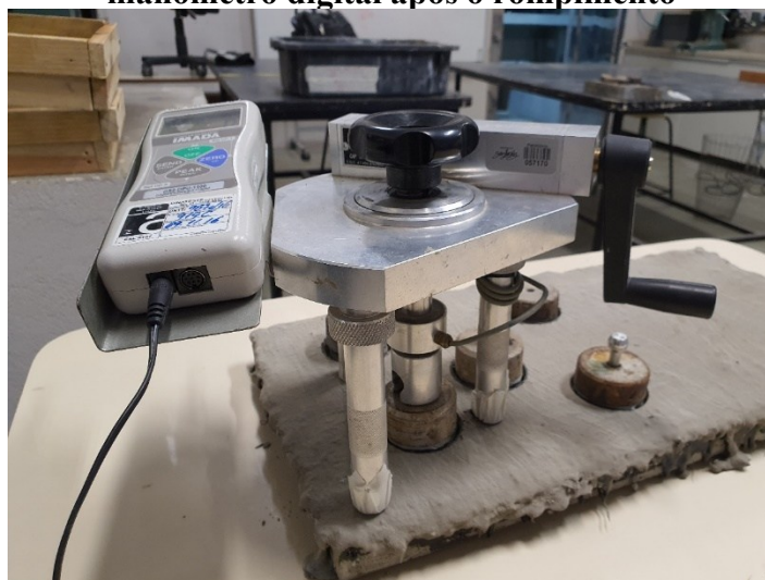
Figura 4 - Ensaio de resistência de tração na aderência: procedimento de encaixe e leitura do manômetro digital após o rompimento
